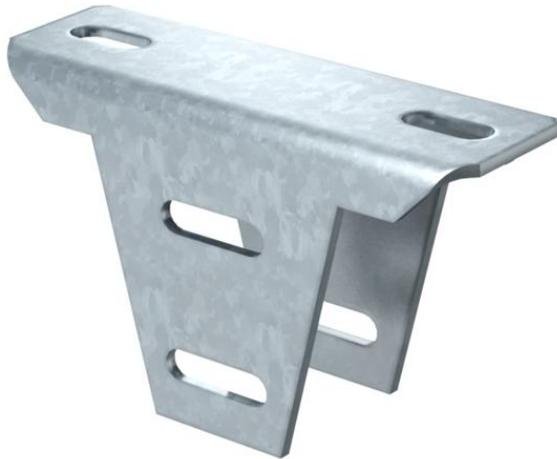
Cabeça de pendural variável para a montagem em perfis US 5. Em combinação com o perfil IS 5, os pendurais podem ser construídos no local em todos os comprimentos. Com a cabeça variável podem ser compensadas inclinações até 30°. Para a montagem da cabeça de perfil é utilizado um distanciador DSK 47, para efeitos de estabilização. O ajuste máximo do ângulo é de aprox. 30°. Fornecido sem parafusos SKS 10 x 80 e distanciador DSK 47.
