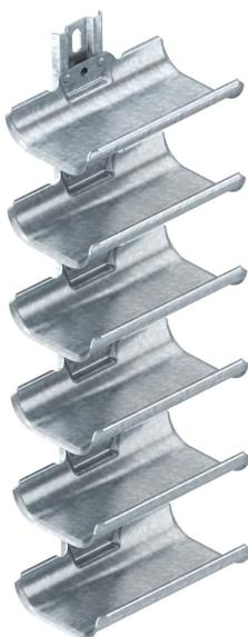
Porta-cabos para uma colocação de cabos simples e rápida em áreas de aplicação em que não possam ser montados sistemas de caminhos de cabos convencionais. Os porta-cabos possuem uma grande superfície de contacto e arestas exteriores arredondadas para a proteção dos cabos. Com base na norma VIN DVE 0298-300, não deve ser excedida a distância de apoio de 0,8 m.
