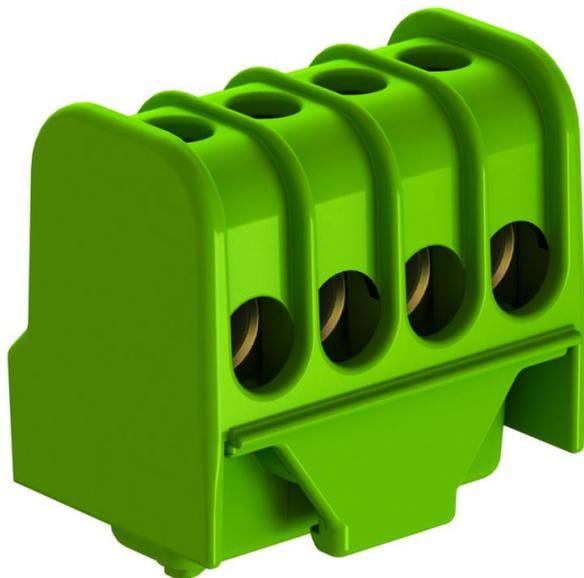
Borne de ligação com condutor de proteção, bornes em latão, parafusos em aço, galvanizado a zinco e passivado de forma transparente, secção transversal nominal  $6 \div 16 \text{ mm}^2$ , tensão nominal 400 V, 1 polo, com bloco de conectores condutores conectáveis máx. por ponto de aperto máx.  $4 \times 16 \text{ mm}^2$ ,  $4 \times 10 \text{ mm}^2$ ,  $8 \times 6 \text{ mm}^2$  ou  $12 \times 4 \text{ mm}^2$ .
