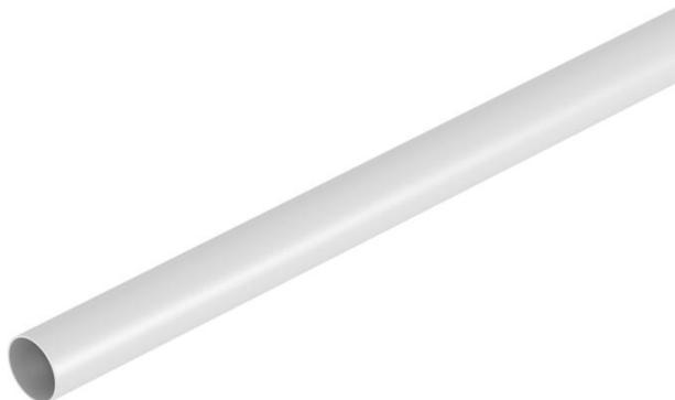
Tubos de instalação elétrica em material plástico livre de halogéneos, conforme EN 61386 (código:44321), para a proteção mecânica de cabos.
