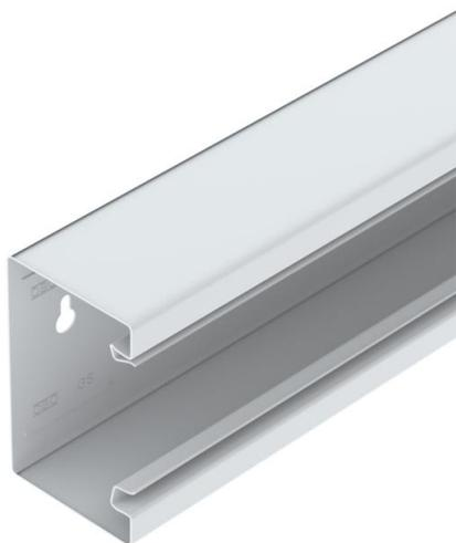
Calha técnica GS para a montagem direta na parede ou nas consolas de fixação. A calha técnica GS dispõe de patilhas de encaixe com contactos para a integração de um separador de chapa de aço. A compensação de potencial entre as bases da calha ocorre através da união. Entre a tampa e a base, a medida de proteção e a ligação equipotencial são garantidas através do encaixe e fixação da tampa na calha. A abertura do sistema é de 76,5 mm. A tampa tem de ser encomendada em separado.
