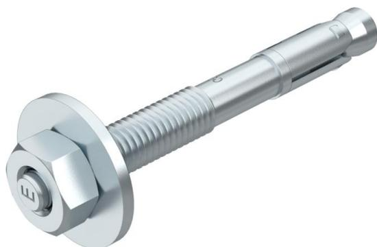
Perno de ancoragem BZ para ancoragem de médias e grandes cargas, tanto em betão armado como não armado. O perno de ancoragem une as cargas elevadas permitidas com pequenas distâncias entre margens e eixos. Avaliação técnica europeia ETA-99/0010, incluindo valores característicos sob efeito de incêndio até uma duração de resistência ao fogo R 120.
