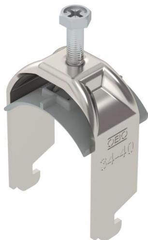
Abraçadeira BBS tipo N, placa de pressão em plástico de polipropileno. Para montagem vertical e horizontal de 1 cabo individual em perfil C. Para largura de rasgo 11 - 12 mm. Com parafuso simples na placa de pressão, cabeça de parafuso hexagonal universal tam. 10, com fenda e fenda em cruz. Adequado para montagem em áreas interiores e exteriores. Recomenda-se o uso de uma contraplaca.
