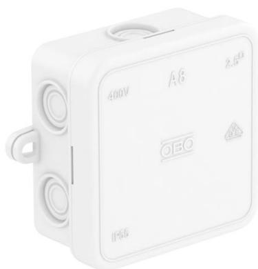
Tipo de proteção IP55, tensão nominal 690 V, secção transversal nominal 2,5 mm<sup>2</sup>, 7 entradas para cabos com diâmetro de 5-14 mm.
