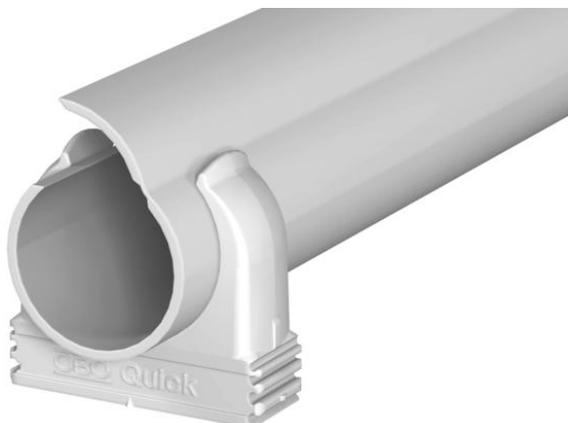
Conjunto de tubos de instalação elétrica Quick-Pipe e abraçadeiras Quick à superfície. Para instalação à superfície de cabos e tubos em áreas interiores e áreas exteriores protegidas. Montagem universal em parede e teto. Inclui 20 m de tubo a cada com 2 metros de comprimento e 60 abraçadeiras Quick. Aplicável na amplitude de temperaturas de - 25° a + 60 °C.
