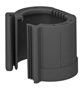
Ponteira divisível para encaixe em tubos de instalação elétrica métricos. A ponteira divisível pode ser utilizada para as reparações corretas em instalações existentes. Não é necessário desconectar os cabos, o que permite uma montagem rápida.
