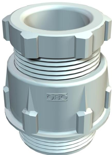
Bucim standard, modelo A conforme DIN 46320 com anel de vedação simples NR/SBR. Rosca PG conforme a DIN 40430.
