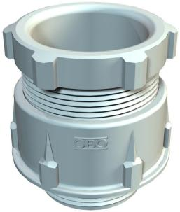
Bucim standard, modelo A conforme DIN 46320 com anel de vedação simples NR/SBR, com rosca métrica conforme IEC 423.
